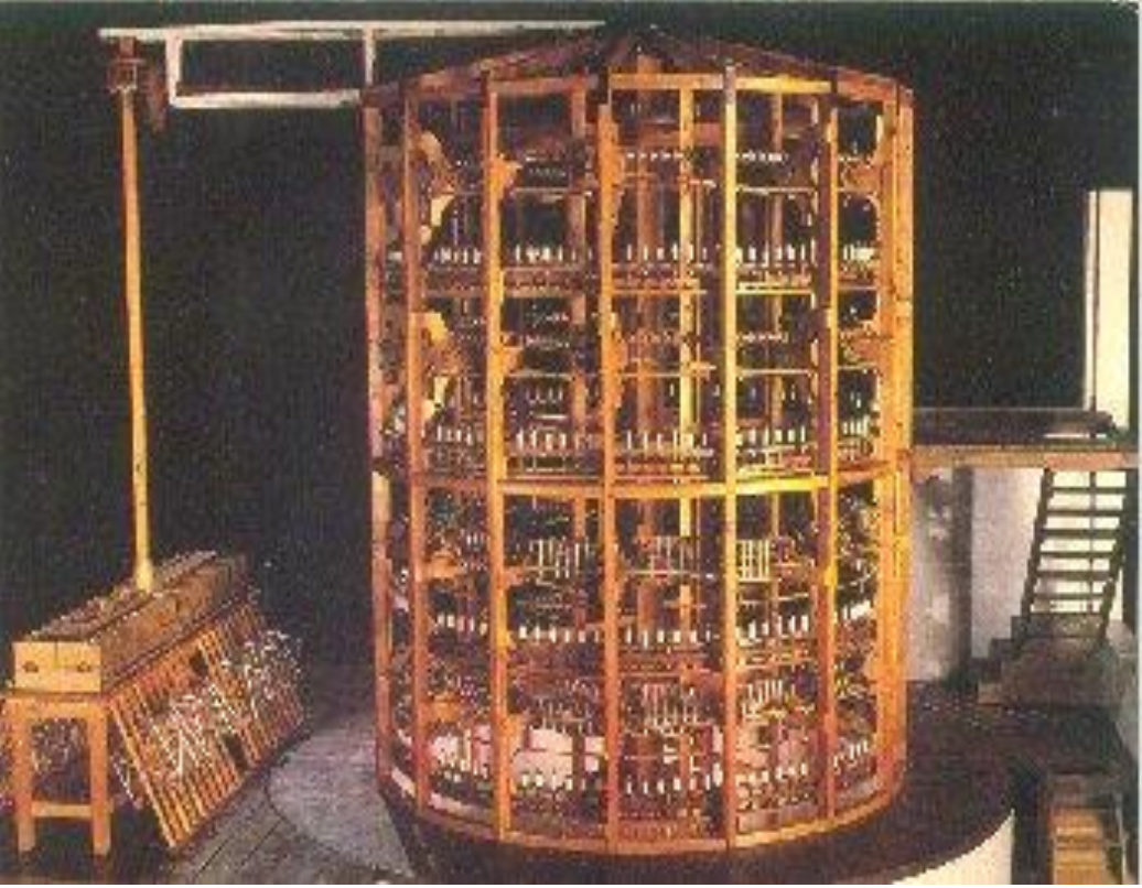
Molino de seta “bolognese” Fuente: Museo del Patrimonio Industrial, Bologna. Recostrucción a escala 1:2
